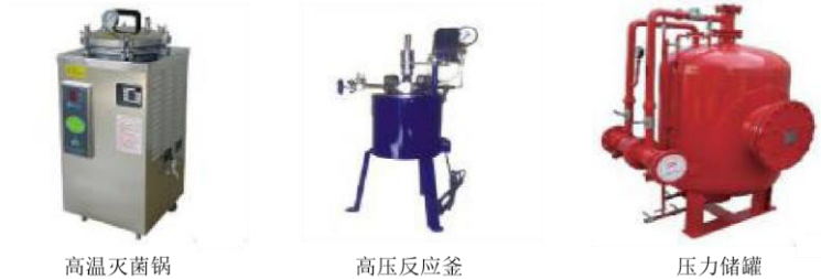
图 8-1 实验室常见高压装置
